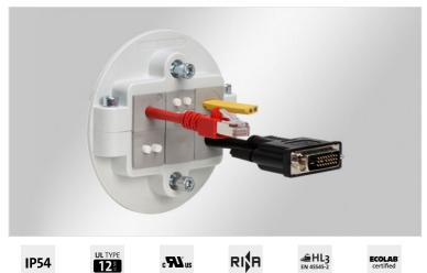
KVT 80可分式电缆格兰头设计用于对带有连接器的电缆进行布线和密封。 同时不带端子或连 接器的电气,气动或液压管线以及波纹管也可以轻松布线(例如引入控制面板,机柜或机械设 备),并满足IP54/UL type 12防护等级。
